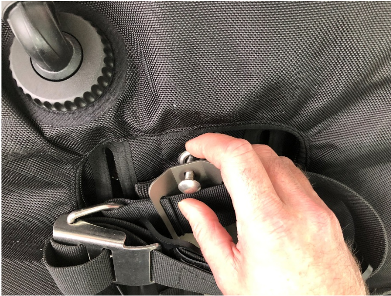
Von der Rückseite den Single Tank Adapter mit Hilfe der Schrauben am Wing und Backplate befestigen
